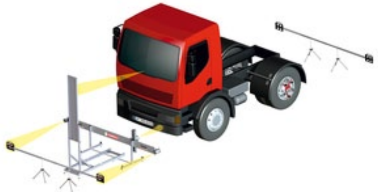
Aufbau der Traversen und des Reflektors vor und hinter dem Fahrzeug
