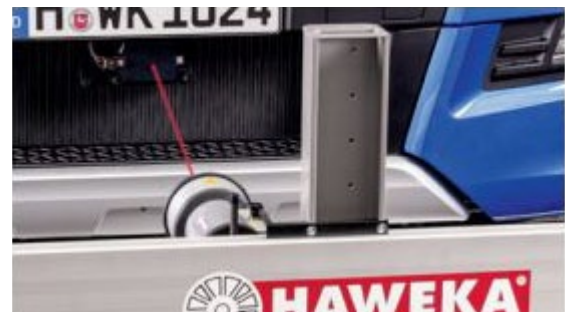
SAD4000-Kamera-Einstellung auf ACC-Sensor
